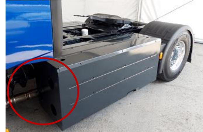
CNG Tank Sicherheitsventil (MARK 137)
